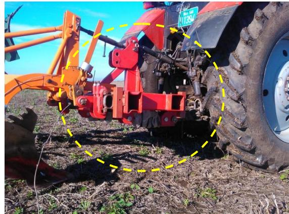
**Slika 2.** Senzorski sistem za merenje mehaničkog otpora obrade zemljišta (Kostić et al., 2014)
