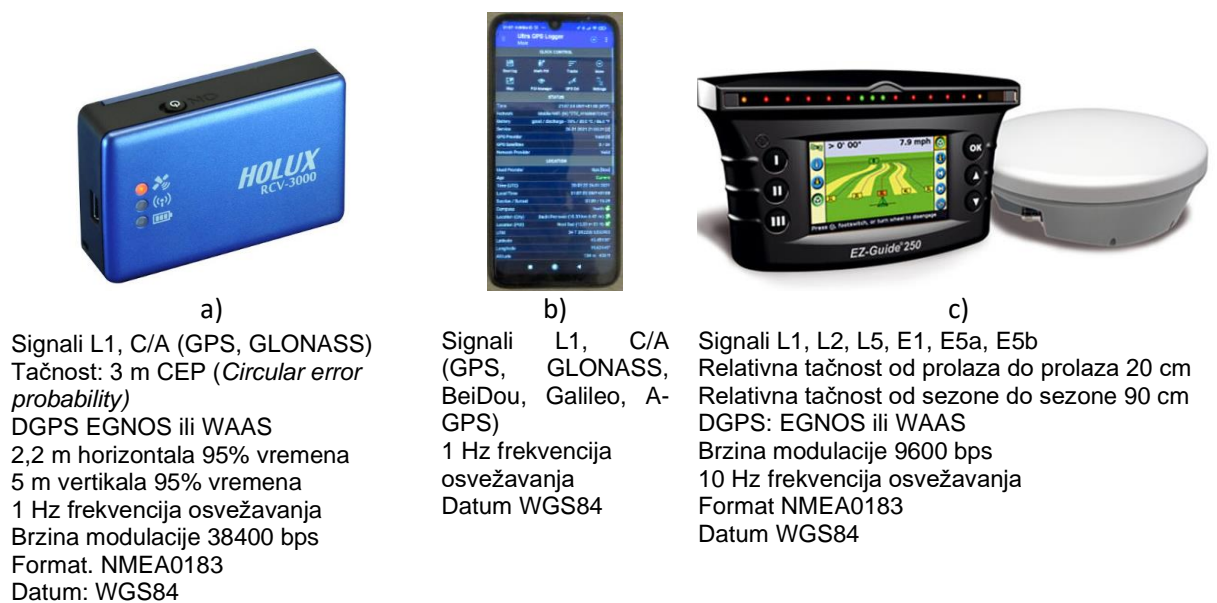
Slika 1. Uređaji koji su korišćeni u ispitivanju relativne tačnosti globalnog pozicioniranja: a) Holux RCV-300, b) Xaiomi Note 7 i c) Trimble EZ-Guide 250
