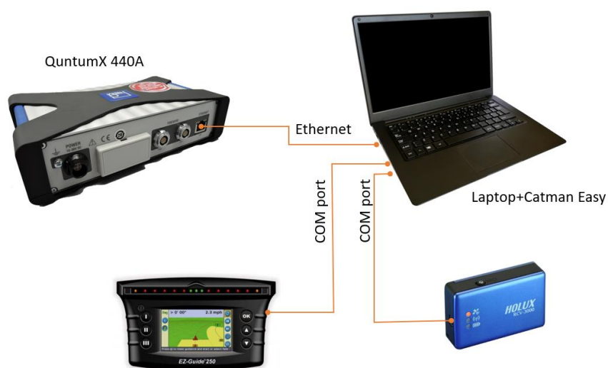
Slika 2. Šema povezivanja akvizicionog modula i GPS prijemnika sa laptopom
